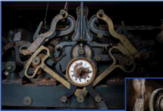
Fotografias do engenho mecânico do relógio de pesos instalado na torre sineira dos paços do concelho de Ribeira Grande.
