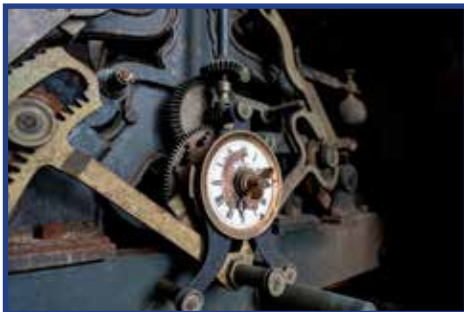
Fotografias do engenho mecânico do relógio de pesos instalado na torre sineira dos paços do concelho de Ribeira Grande.
