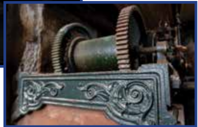
Fotografias do engenho mecânico do relógio de pesos instalado na torre sineira dos paços do concelho de Ribeira Grande.
