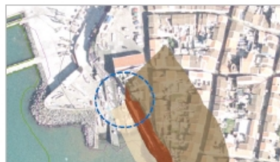
Verificação da delimitação de arriba e, consequentemente, da faixa de proteção da base
